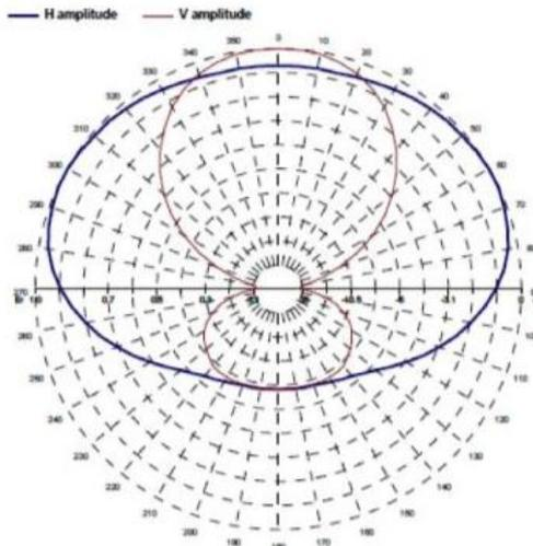
Se observa que los azimuts de máxima radiación se encuentran a 30 y 150 grados; y que la dirección de apuntamiento de la antena es de 90 grados.
